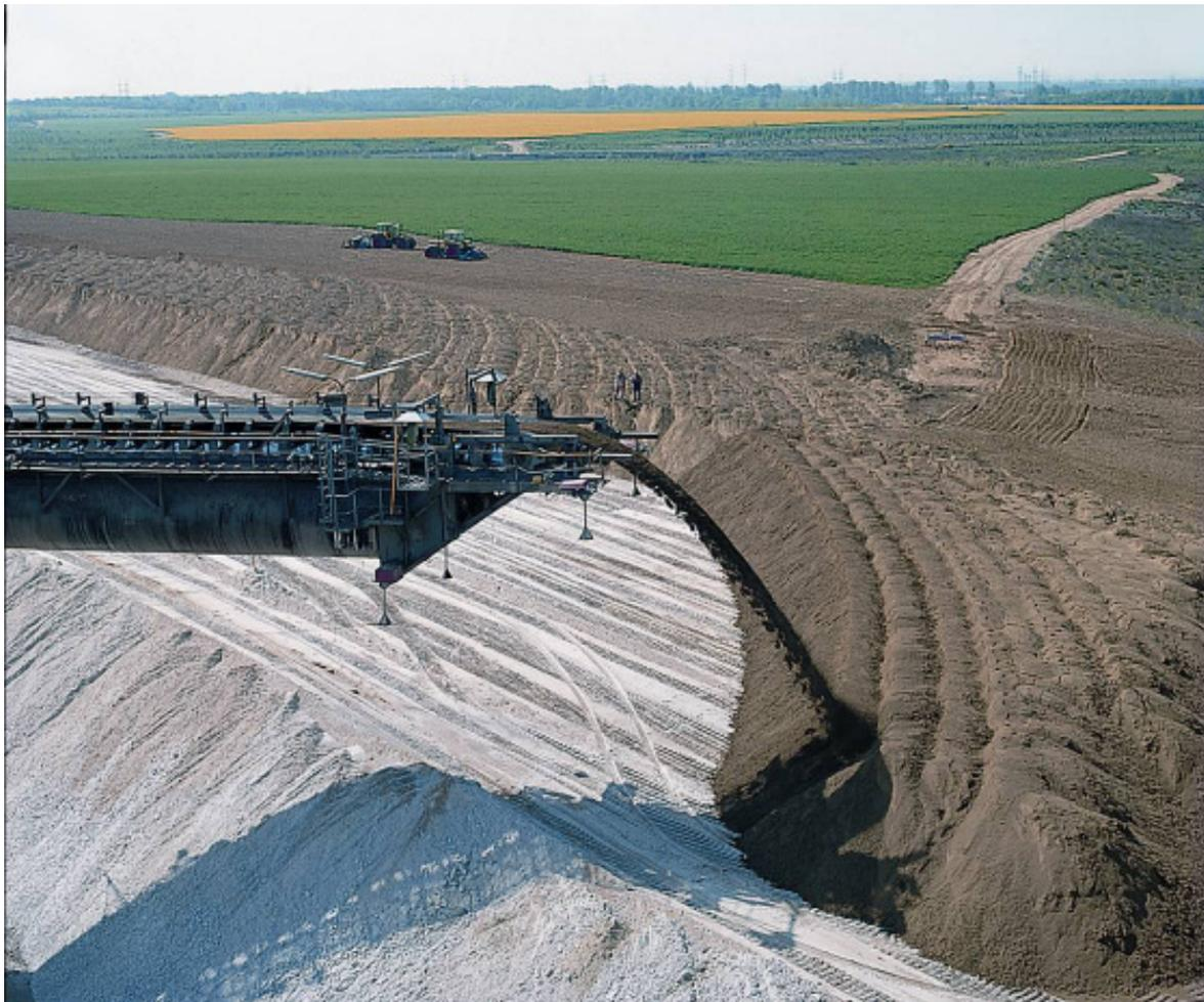
Abbildung 10: Trockener Lössauftrag mit dem Absetzer.
