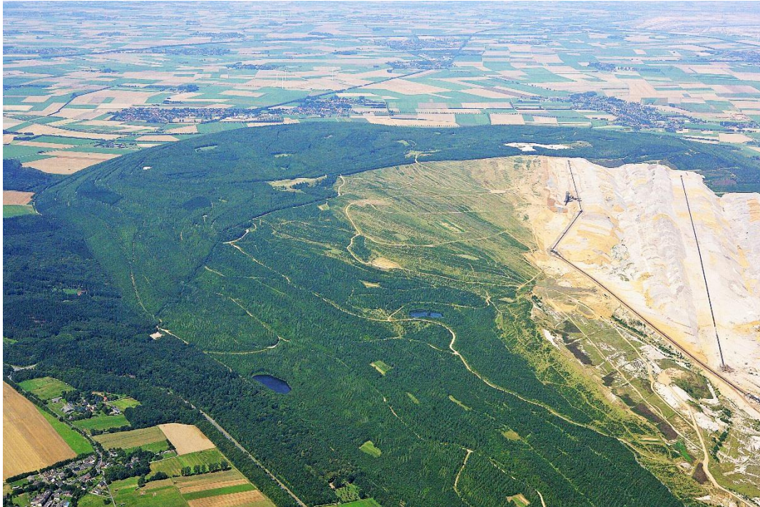
Abbildung 3.6: Luftaufnahme von der Sophienhöhe beim Braunkohlentagebau Hambach. Im Vordergrund ist die natürliche Gestaltung der überhöhten Innenkippe mit ihren Seen zu sehen – im Vergleich dazu die Außenkippe im Hintergrund, deren Form noch der eines Tafelbergs gleicht. (Forschungsstelle Rekultivierung, 2007).
